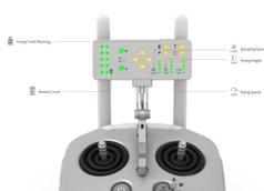
Il telecomando dedicato al modello MG-1 è dotato dell'ultimo sistema di trasmissione Lightbridge 2 che consente controlli "ultra low latency" controlli estremamente precisi senza margini di errore. Così come il corpo del drone, il telecomando è stato progettato con resistenza all'acqua e alla polvere. Un pannello display a basso consumo energetico fornisce le informazioni sui voli in tempo reale e con una sola carica ha una durata elevata. Dotato di batteria incorporata.
