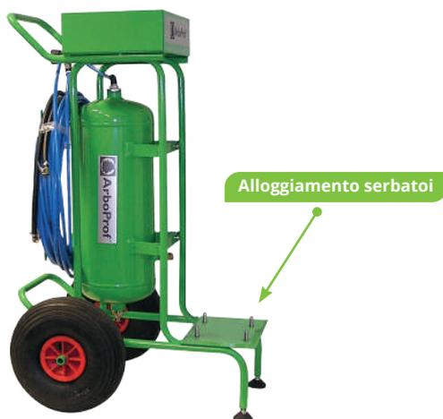
Carrello dotato di serbatoio d'aria da 15 litri, fino a 8 bar. Norma CE, vano porta utensili, 2 ruote ad ampio battistrada e due piedi di posa per un fermo fissaggio in ogni terreno. Dotato di uscite singole o multiple a pressione costante. Predisposizione base per alloggiare due serbatoi liquidi.
