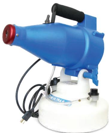
Dotato di ventilatore a due stadi e robusta valvola dosatrice assicura l'erogazione di particelle inferiori ai 20 micron, indipendentemente dalla portata e dalla viscosità del liquido irrorato. Costruito in polietilene ad alta densità. La valvola di precisione consente di regolare l'erogazione del prodotto fino a 70 ml al minuto.
