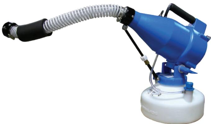
Provisto di tubo flessibile di circa 50 cm per trattare condutture, controsoffitti o altri luoghi difficilmente accessibili o che richiedono applicazioni sigillate. Il ventilatore a due stadi e robusta valvola dosatrice assicura l'erogazione di particelle inferiori ai 20 micron, indipendentemente dalla portata e dalla viscosità del liquido irrorato.
