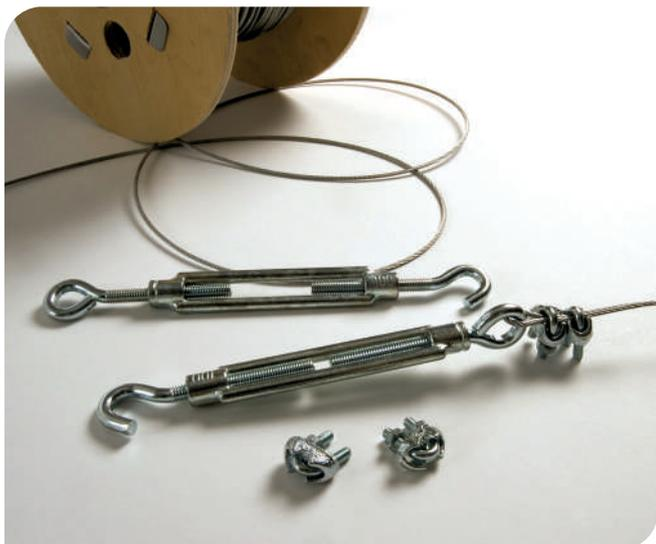
Il cavo metallico di 2 mm di diametro è adatto per la maggior parte delle reti. Fatto con 49 fili in una configurazione di 7/7, il cavo metallico consente una buona flessibilità. Disponibile in acciaio inox (Professionale) e in acciaio galvanizzato (linea economica) in bobine da 50 m e 200 m. I tenditori occhio/gancio M6 sono adatti per la maggior parte di reti. Le graffette di rame da 2,5 mm dovrebbero essere usate con il cavo metallico e le graffette di alluminio con il cavo galvanizzato.
