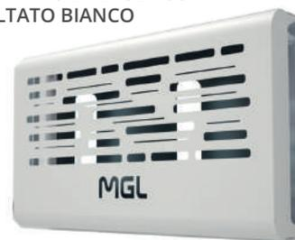
Consuma il 20% in meno rispetto ad una fonte di illuminazione a neon. Dotata di 2 tubi compatti da 20 W a 220 V e di piastra collante. La griglia frontale decorata, consente la diffusione della luce UV riducendo la visione degli insetti catturati. Dotata di apertura del pannello frontale a 90° che garantisce una facile manutenzione.
