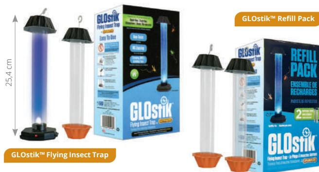
Trappola per insetti volanti caratterizzata da un tubo di colla monouso, utilizzando una luce a LED alimentata a batteria. Il cappuccio riflettente intensifica l'attrazione degli insetti. La lampadina a LED dura fino a 10.000 ore. La trappola esplica la sua funzione nella notte, durante la quale deve essere accesa per intrappolare gli insetti volanti che sono entrati durante il giorno.
