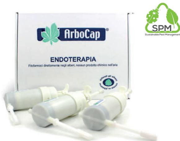
Arbocap è una speciale capsula ricaricabile in materiale plastico resistente, che consente il trattamento tramite endoterapia da parte dell'utilizzatore tecnico-professionale. La pressione necessaria per iniettare la soluzione, si ottiene caricando la molla interna ad una pressione di 0,5 bar sufficiente per immettere la soluzione all'interno del legno attivo (xilema).
