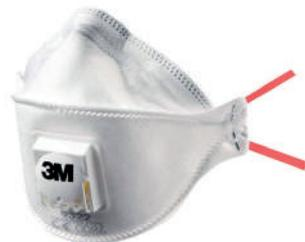
Maschera facciale usa e getta con protezione FFP3 (polveri, fibre e fumi derivanti da particolato ad alta tossicità). Impiegabile fino a 30 x TLV del particolato.
