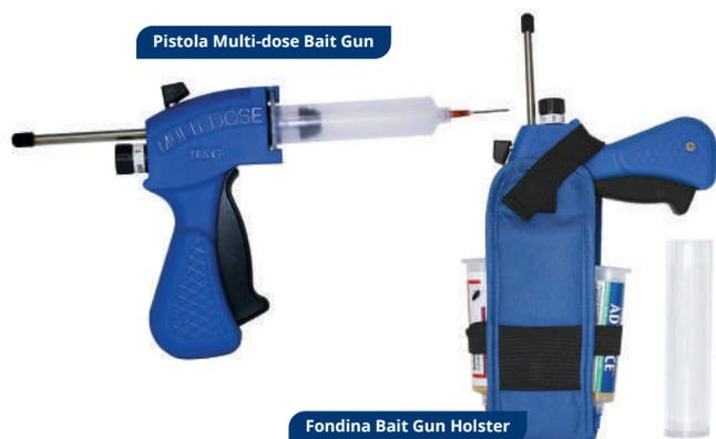
Compatibile con cartucce di gel da 30/35g. Agisce per pre-compresione permettendo la fuoriuscita del gel in maniera precisa e mirata; La quantità di esca erogata può essere regolata utilizzando il quadrante sul retro della pistola, la manopola di regolazione può essere impostata su **4 diversi impostazioni**:
