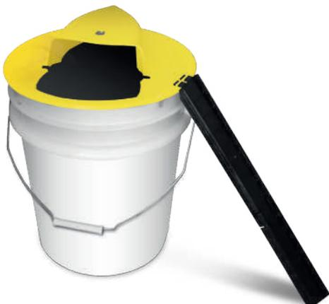
Coperchio in plastica, facilmente installabile e posizionabile su un normale secchio acquistabile separatamente. Permette la cattura dei topi senza ucciderli grazie alla botola ribaltabile. Il roditore, una volta salito sulla rampa e raggiunta la pedana, a causa dell'apertura della botola, cadrà all'interno del secchio. La pedana ritorna istantaneamente in posizione riattivandosi per un altro roditore.
