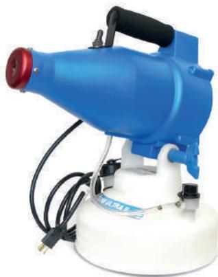
Dotato di ventilatore a due stadi e robusta valvola dosatrice assicura l'erogazione di particelle inferiori ai 20 micron, indipendentemente dalla portata e dalla viscosità del liquido irrorato. Costruito in polietilene ad alta densità. La valvola di precisione consente di regolare l'erogazione del prodotto fino a 70 ml al minuto.
