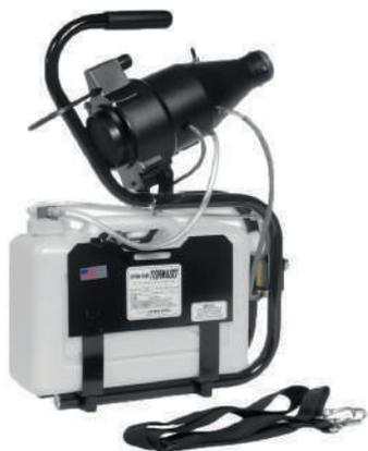
Ideale per trattamenti di umidificazione in serre e vivai, per interventi di disinfestazione e per l'erogazione di disinfettanti e germicidi. Produzione di goccioline da 10 a 40 micron.
