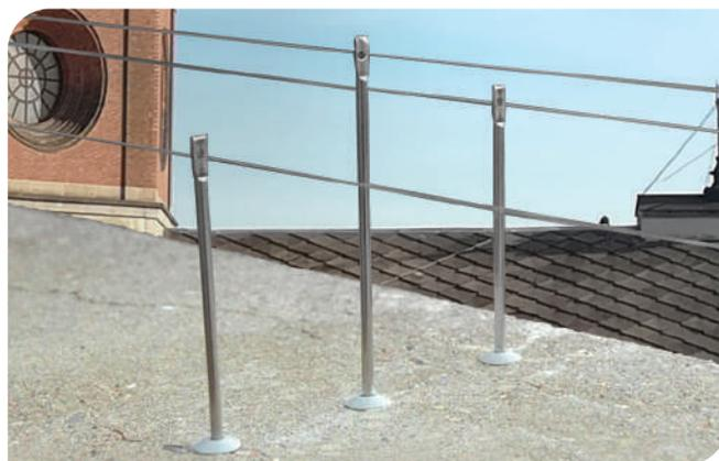
L'impianto è costituito da un cavo in acciaio sorretto alle estremità da pilastri ed ancorato da un lato tramite una molla. È possibile ancorare i pilastri tramite tasselli o basi e mastice, mantenendo una distanza lineare tra ogni punto di fissaggio non superiore a 1,5 metri. Il numero di file parallele varia in base alla superficie da proteggere e al volatile; è consigliato non eccedere comunque i 75 mm tra un filo e l'altro.
