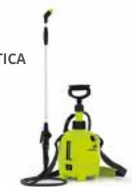
**Pompa Profession 7 con serbatoio da 7 litri** e lancia telescopica in alluminio estendibile da 75-135 cm. Dotata di 2 tipologie di ugelli regolabili, di valvola di sicurezza max 4 bar (pressione massima di esercizio), valvola di sfiato, spallaccio imbottito per il trasporto e protezione anti-pieghe per la tubazione. Indicata per trattamenti con soluzioni di biocidi, fitosanitari e disinfettanti. Peso a vuoto 1,8 Kg. Altezza 470 mm. Larghezza 220 mm.
