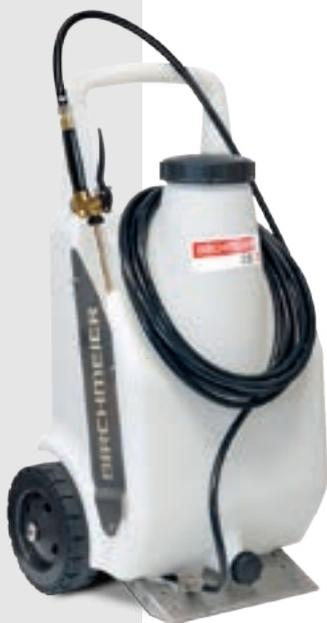
Pompa carrellata **C 50 AC1** con serbatoio da 50 litri ad alta pressione e sistema CAS, con zero emissioni di CO<sub>2</sub>. Il sistema pompante a membrane di alta qualità che consente di generare fino a 6 Bar di pressione e funzione di miscelazione attivabile a piacere. C 50 è dotata di freno di stazionamento.
