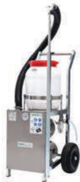
**Unipro 5** è un ULV, attrezzatura a Ultra Basso Volume, carrellato. Consente di effettuare velocemente ed efficacemente, trattamenti insetticidi e disinfettanti in ambienti di grandi volumi; utilizzabile con presa a 220 V. L'ugello può essere alzato fino ad un'altezza di 2 metri ed è regolabile a 360° in orizzontale e 180° in verticale. Caratterizzato da bassa rumorosità ed elevata affidabilità e sicurezza operativa, il motore, incapsulato, non ha bisogno di manutenzioni.
