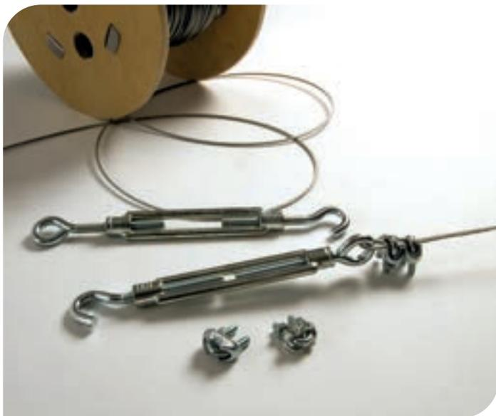
Il cavo metallico di 2 mm di diametro è adatto per la maggior parte delle reti. Fatto con 49 fili in una configurazione di 7/7, il cavo metallico consente una buona flessibilità. Disponibile in acciaio inox (Professionale) e in metallo galvanizzato (linea entry level) in bobine da 50 m. e 200 m. I tenditori occhio/gancio M6 sono adatti per la maggior parte di reti. Disponibili sia in acciaio inox che in metallo zincato a seconda delle esigenze del cliente.
