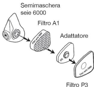
**Adattatore** per assemblare filtri diversi (A1+P3) per la protezione combinata da polveri, gas e vapori organici.
