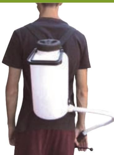
**Dosamatic® GR** è dotato di un serbatoio da 10 litri e spallacci per il trasporto, consente un'erogazione regolabile da 2 a 10 g di prodotto granulare. Può essere utilizzato in tutti gli interventi dove sia richiesta una precisione del dosaggio di formulati anti-larvali granulari specialmente per tombature, grigliati e bocche di lupo.
