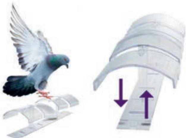
**Pigeon Free System** è un efficace sistema di allontanamento per volatili che utilizza una superficie liscia e basculante. Questa oscillazione scoraggia i volatili cercando un punto d'appoggio, senza causare danni fisici. Il dissuasore è realizzato con materiali polimerici resistente agli agenti atmosferici e alle deiezioni dei volatili, riducendo la necessità di manutenzione e sostituzione.
