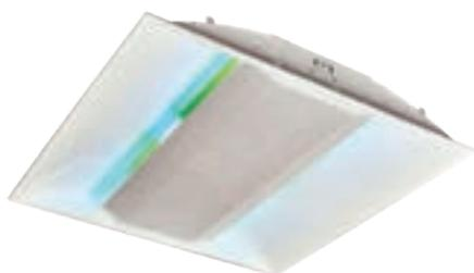
**PG40LB** è una lampada laccata bianca dotata di 2 tubi compatti da 20 W e di piastra collante. Posizionamento e fissaggio all'interno dei moduli di controsoffittiature da 60x60 cm. L'apertura a 90° consente una facile manutenzione.
