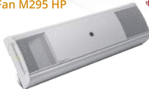
Dotata di una struttura portante in estruso di alluminio verniciato a polveri epossidiche e un coperchio anteriore con microfori che permettono l'ingresso e l'uscita dell'aria alle due estremità, facendola passare attraverso il filtro TIOX®. La camera germicida ospita le lampade UV-C ed è costruita in uno speciale alluminio purissimo a specchio che amplifica il potere disinfettante delle lampade
