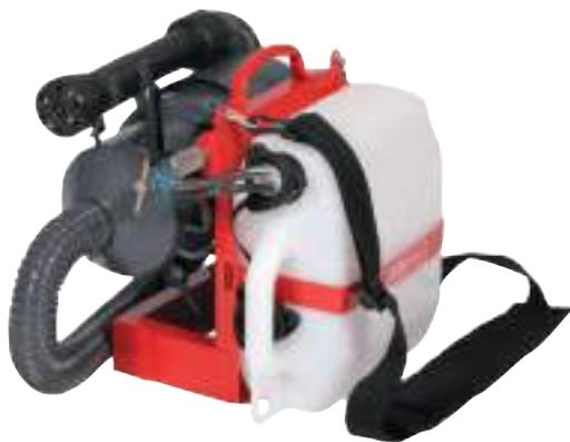
Nuova linea di Turbo ULV particolarmente dedicata alla sanificazione, sostituite tutte le parti in rame e bronzo a contatto con la soluzione con elementi in acciaio inossidabile. Turbina ad alta prestazione che crea un forte getto d'aria che raggiunge i 50 litri/secondo. Il formulato viene atomizzato in aerosol fine, regolabile da 10 fino a 100 µ, in base al flusso definito dalla misura dell'ugello utilizzato.
