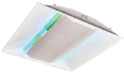
Lampada laccata bianca dotata di 2 tubi compatti da 20 W e di piastra collante. Posizionamento e fissaggio all'interno dei moduli di controsoffittiature da 60x60 cm. L'apertura a 90° consente una facile manutenzione.
