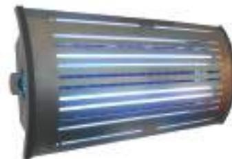
Dotata di 2 tubi U.V. da 15W e di piastra collante. Il frontale anteriore è in grado di ruotare per consentire un libero accesso facile e veloce ai tubi UV ed alla piastra collante. Dotata di finiture in policarbonato grigio cobalto stabilizzato ai raggi UV. Installabile sia in orizzontale che in verticale.
