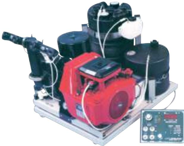
Equipaggiato con 4 ugelli azionati da un potente compressore volumetrico coassiale ad un motore bicilindrico da 18 Hp, permette con particolari regolazioni di pressione di erogare il 90% del formulato con particelle al di sotto dei 20 $\mu$ .
