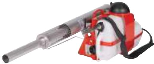
Idoneo per prodotti liquidi a base acqua e a base solvente. Non idoneo per sospensioni (polveri bagnabili). Accensione automatica e congelamento di avviamento con pompa a mano. L'espulsione della nebbia è di 10 - 35 l/h (secondo l'ugello applicato) e 12 l/h con quello standard. La valvola di controllo per la nebulizzazione manuale combinata con l'interruttore automatico della sostanza attiva, cut-off device, è inclusa.
