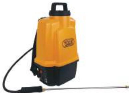
Serbatoio da 12 litri. Con un'irrorazione a 2 bar, la durata di carica della batteria arriva fino a 9 ore, mentre a 0,5 bar la durata può arrivare fino a 15 ore. Le guarnizioni sono in NBR, resistenti ad elevati carichi di rottura, agli oli minerali e ai grassi. Gli ugelli in dotazione sono 2: in ottone regolabile per irrorazione e in ottone e resina acetalica a ventaglio ideale per il diserbo.
