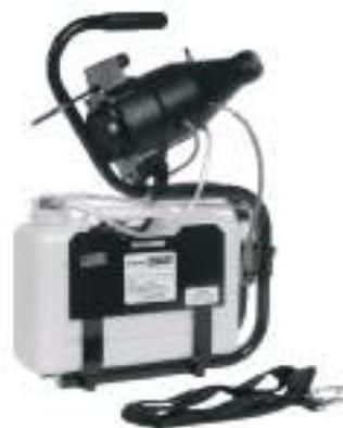
Ideale per trattamenti di umidificazione in serre e vivai, per interventi di disinfestazione e per l'erogazione di disinfettanti e germicidi. Produzione di goccioline da 10 a 40 micron. Equipaggiato con un serbatoio estraibile per il prodotto, filtro e valvola di erogazione di precisione che consente di regolare il consumo fino a 26 l/h.
