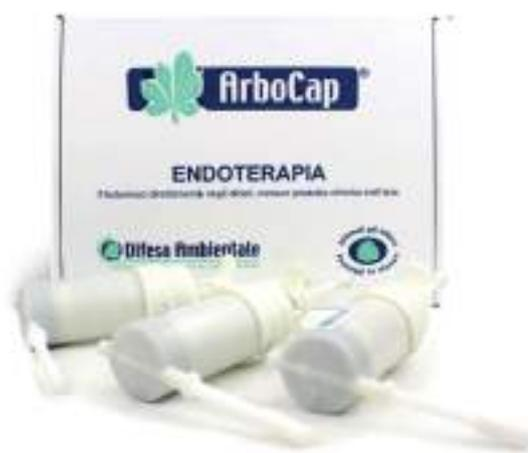
Arbocap è una speciale capsula ricaricabile in materiale plastico resistente, che consente il trattamento tramite endoterapia da parte dell'utilizzatore tecnico-professionale. La pressione necessaria per iniettare la soluzione, si ottiene caricando la molla interna ad una pressione di 0,5 bar sufficiente per immettere la soluzione all'interno del legno attivo (xilema).
