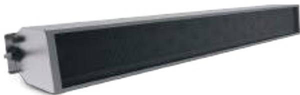
Dotata di struttura in acciaio INOX e lamelle direzionali nere a nido d'ape che incanalano il flusso dei raggi UV. L'installazione, grazie anche all'ausilio di particolari staffe che ne dirigono il flusso, può essere fatta in modo da formare una "lama UV" che partendo dall'apparecchio irradia verso il pavimento (barriera UV-C) o verso il soffitto se si vogliono trattare gli strati superiori degli ambienti.
