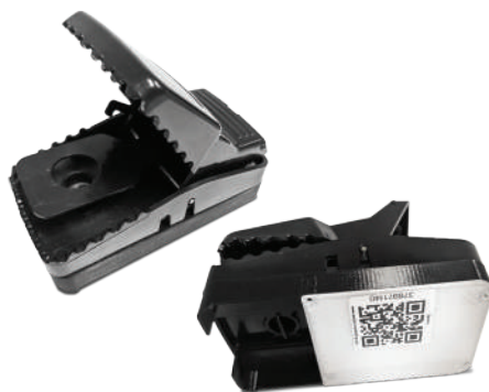
sensore di cattura integrato in trappola a scatto
